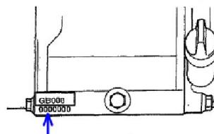
NO.11のクリップとNO.13のフューエルホースが変更されています。エンジン号機0054656以前のエンジンが該当します。エンジン号機0054657以降のエンジンは(新)のパーツリストをご覧ください。
