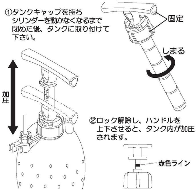
③噴霧適正圧力になり安全弁から「シュー」という音が聞こえたら加圧をやめて下さい。(この時、安全弁の赤色ラインが見えることにより確認できます。)
