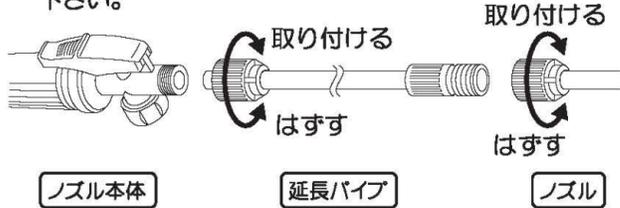
**注意** 接続部にはパッキンが付いています。必ずパッキンがあることを確認して下さい。また、液漏れがないようしっかりと締め付けて下さい。
