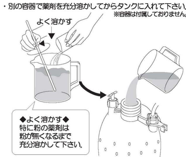
**注意** 前回使用した薬剤が残っていないか確認して下さい。化学反応を起こし、有毒ガスが発生する危険があります。
