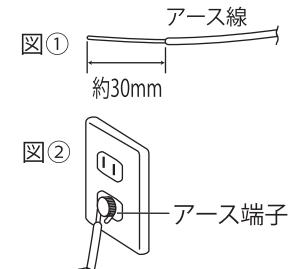
② アースクリップによる取り付けが不安定な時は、アース線からクリップ部を切り取りアース線先端を約30mmむき出して下さい。(図①参照) その際、芯線を傷つけないようにしてください。折れることがあります。アース線の芯線をコンセントのアース線に巻きつけて、確実に固定してください。(図②参照)
