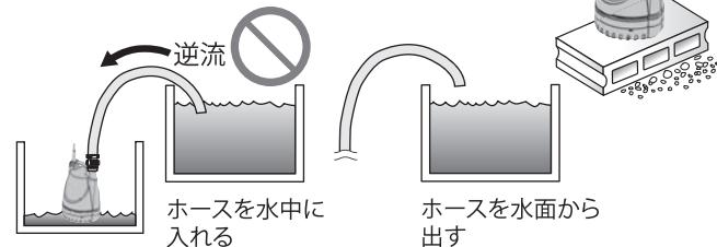
**△ 注意** 吐出ホースの先端が吐出側の水中に入っている場合、ポンプ停止時にサイフォン現象により水が逆流します。
