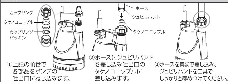
**△ 注意** ホースの取り付けは製品付属の部品をご使用の上、確実に行ってください。又、取り付け順を誤ると水漏れの原因となります、ご注意ください。
