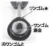
ワンゴム座金をはずし、 新しいワンゴムに交換し、 逆の手順でとりつける ※ワンゴムは持手にはめ込 んでから押さえネジを取 り付けてください。
