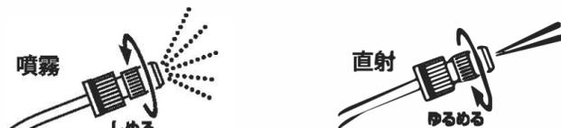
②噴霧の状態に合わせて、ピストンによる加圧をくり返してください。 ※ゆるめすぎないでください。接続部から液がふきだします。
