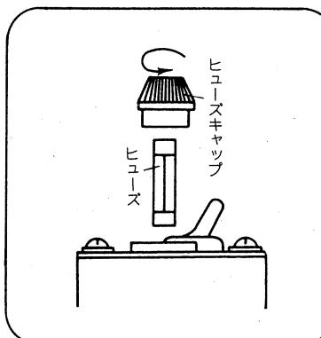
ヒューズは指定容量以上の電流が流れると自動的に切れます。その場合は、ヒューズキャップを矢印の方向に廻して取り外し、中からヒューズを取り出して、新しいヒューズと取替えて下さい。
