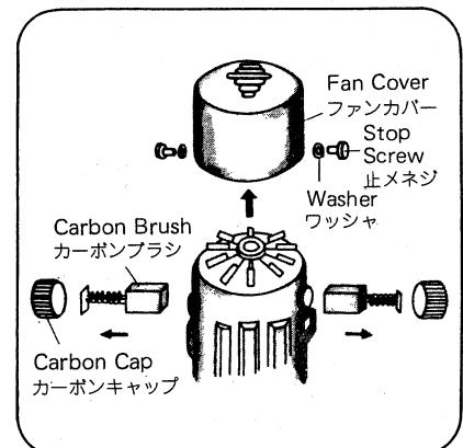
1. ファンカバーの3カ所の止めネジをドライバーにて取り外し、ファンカバーをモートルから外して下さい。
