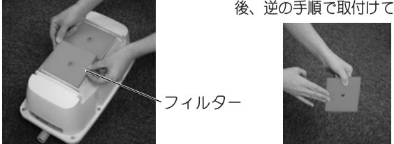
③フィルターについていた塵埃を叩き落とし、水洗い(洗浄後、完全に乾燥させる)してください。清掃後、逆の手順で取付けてください。
