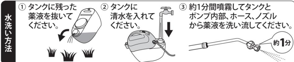
**注意** タンク、ポンプ及びノズル内の薬液を完全に抜いてから保管してください。薬液が固まったり、凍結し故障の原因となります。また、タンクがノズルより上にある場合、残った薬液がノズルから溢れ出すことがあります。(サイホン現象)
