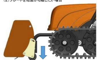
1)③サイドローラー固定ボルトを緩めて、サイドローラーを下げます。 2)任意の高さで、③サイドローラー固定ボルトをしっかり締めます。
