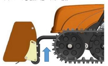
1)③サイドローラー固定ボルトを緩めて、サイドローラーを持上げます。 2)任意の高さで、③サイドローラー固定ボルトをしっかり締めます。
