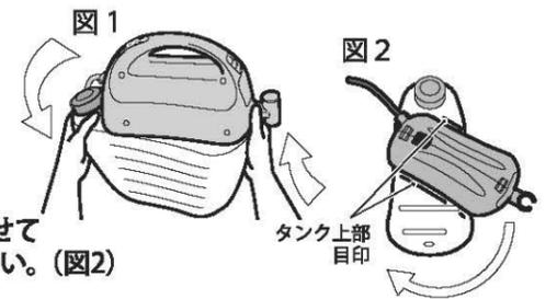
取り付けはタンク (白) の上部の線に合わせて本体 (黄色) をのせて、回してつけてください。(図2)
