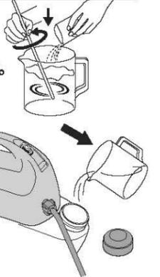
**注意** 薬液は規定容量以上入れないでください。前回使用した薬剤が残っていないか確認してください。化学反応を起こし、有毒ガスが発生する危険があります。
