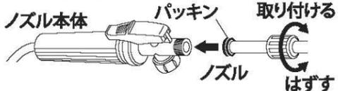
**注意** 接続部にはパッキンが付いています。必ずパッキンがあることを確認してください。また液漏れがないようしっかりと締め付けてください。
